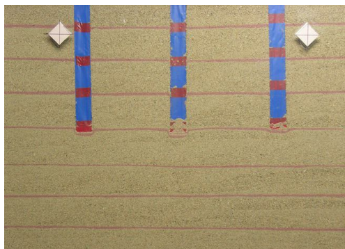
图 4 某级荷载下桩端附近桩土位移
